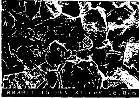
圖 7、T-250 H900 時效處理缺口試件於氣態氫環境中之拉伸破斷面
