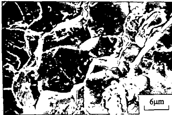
圖 5. T-250 經 H900 時效處理於硫化氫環境拉伸破斷面。
